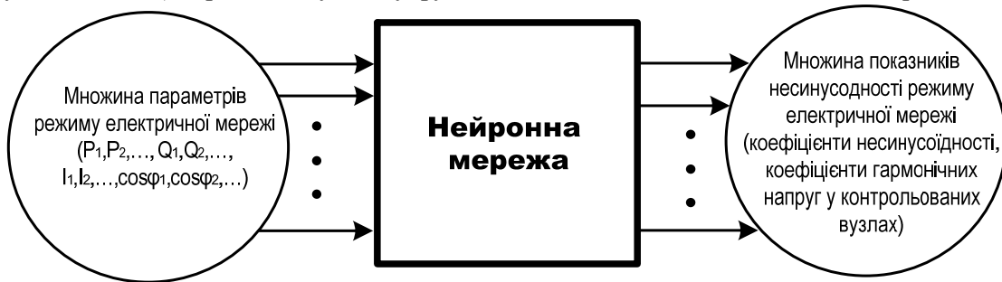
Рис. 1. Принципова схема функціонування системи ідентифікації несинусоїдного режиму
