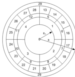
Рис. 2. Схема сегментації плямоподібного зображення лазерного променя
