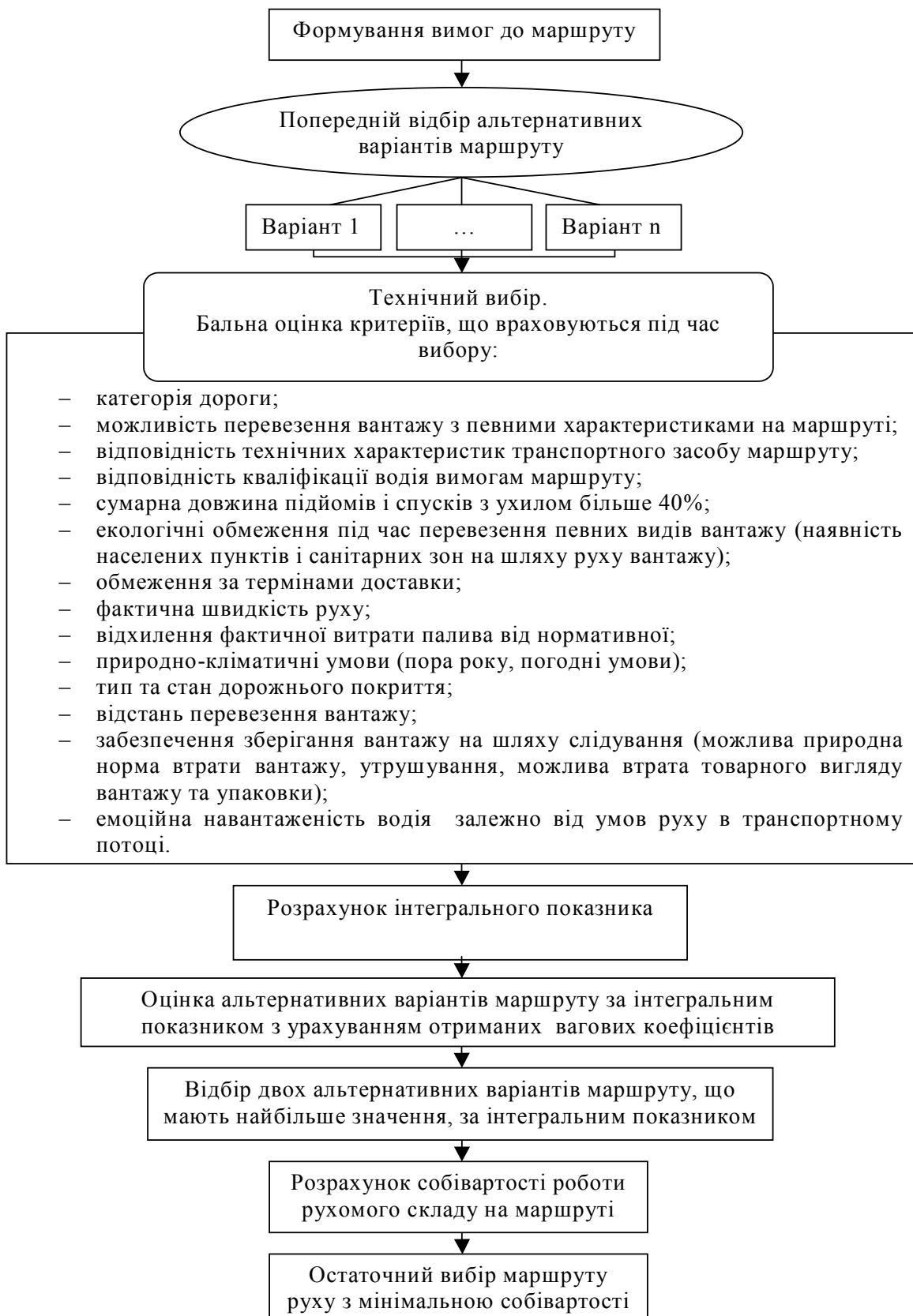
Рис. 1. Структурно-логічна схема вибору раціонального маршруту руху
