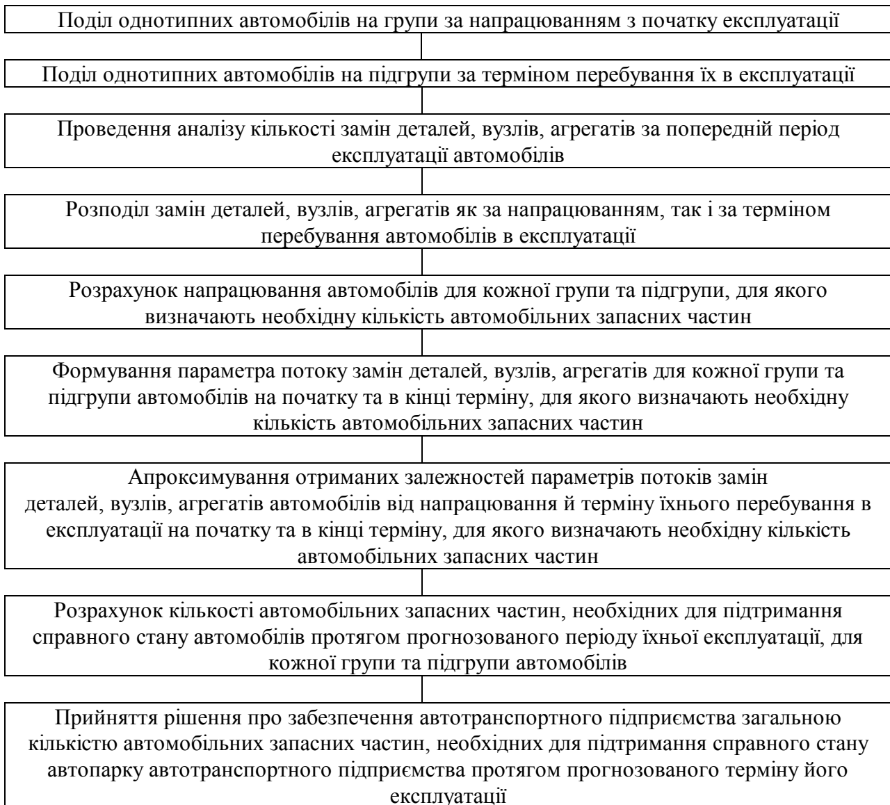
Рис. 1. Алгоритм реалізації методу формування кількості запасних частин для ремонту засобів транспорту
