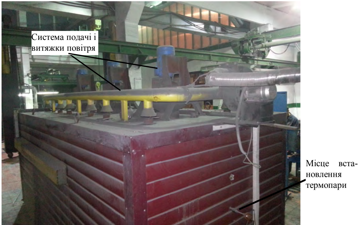
Рис. 2. Система подачі і витяжки повітря прожарювальної печі
