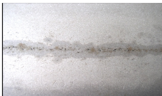
Рис. 1. Макроструктура поздовжнього темплету безперервнолитої заготовки зі сталі С80D (швидкість витяжки 3,4 м/хв; питома витрата води в ЗВО 1,30 л/кг)
