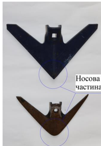
Рис. 1. Новий та зношений робочий орган (стрілчаста лапа) ґрунтообробної машини
