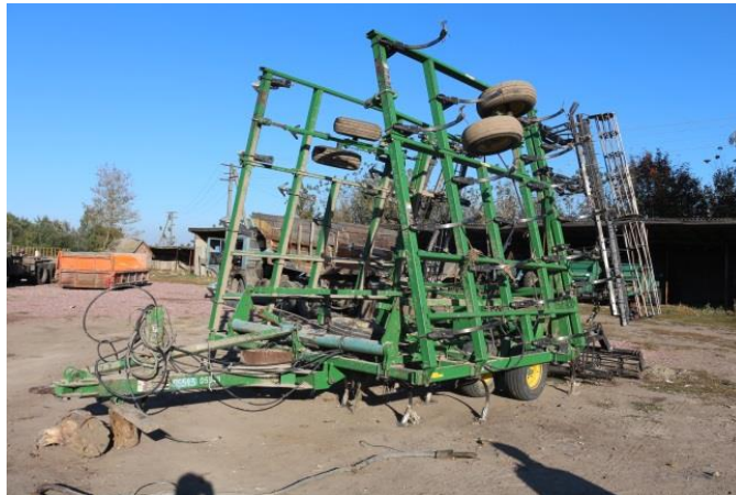
Рис. 5. Культиватор «John Deere 2210», який використовували для визначення особливостей зношування стрілчастих лап на різних типах ґрунтів
