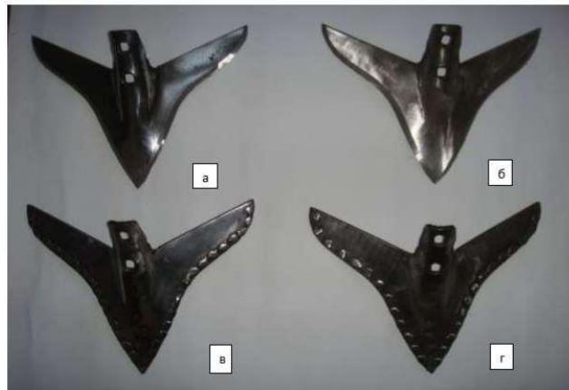
Рис. 3. Експериментальні культиваторні лапи: а – монометалеві з криволінійною формою леза; б – експериментальні з нижнім локальним зміцненням леза; в, г – експериментальні з верхнім локальним зміцненням леза [2]
