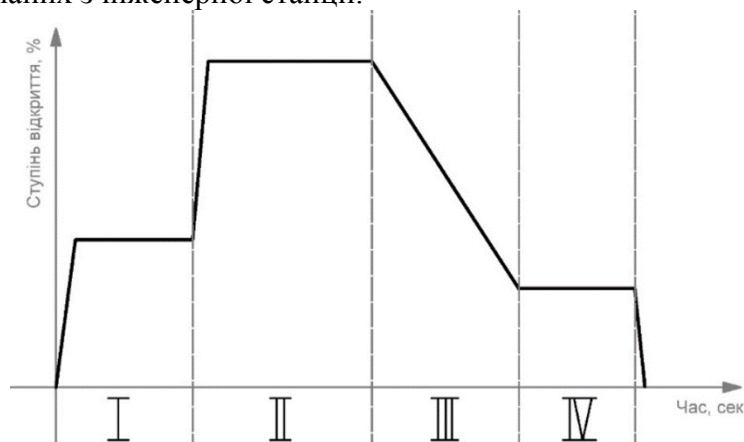
Рис. 2. Графік зміни ступеня відкриття перетискного клапана під час наповнення флакона: I – етап передозування, II – швидке дозування, III – напівточне дозування, IV – точне дозування.
