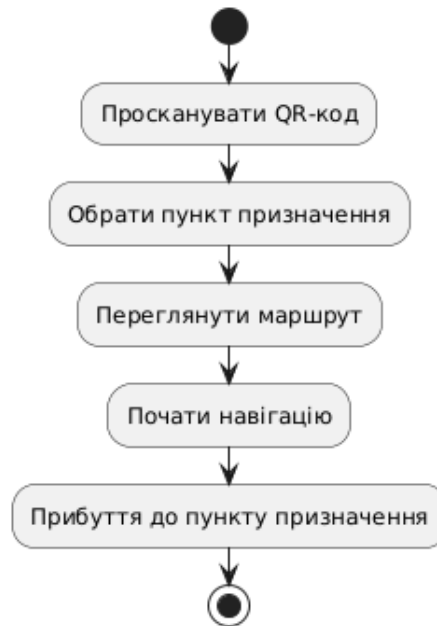
Рис. 5. Узагальнена діаграма активності програмного забезпечення для віртуального супроводу пацієнтів
