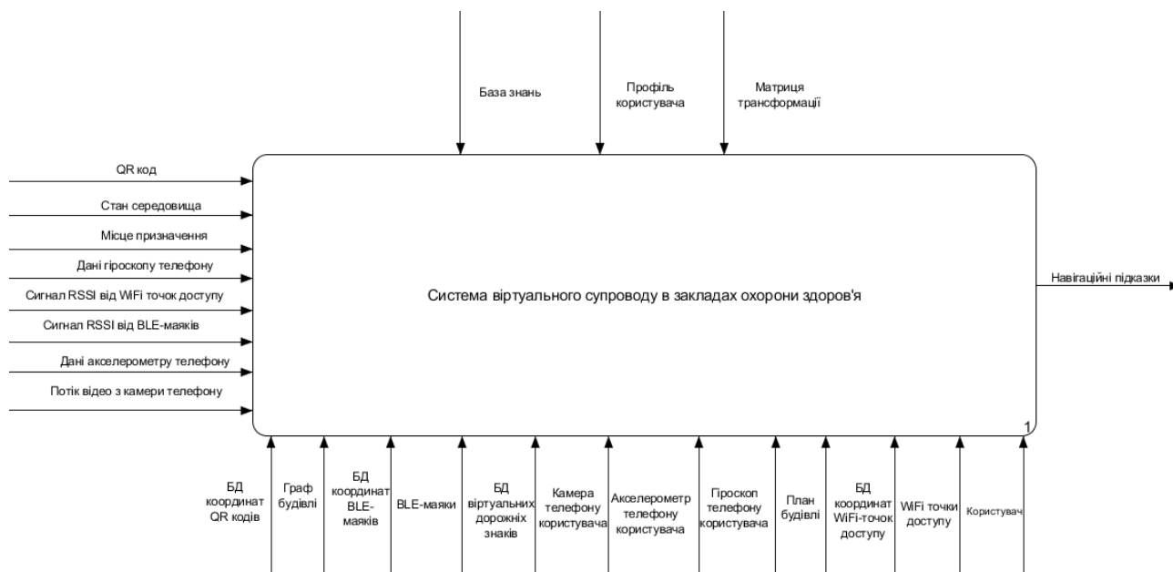
Рис. 2. Контекстна діаграма A-0 системи віртуального супроводу в закладах охорони здоров'я
