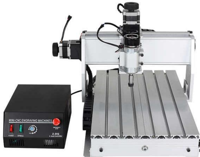
Рис. 2. CNC 3040 трьохосьовий фрезерно-гравірувальний верстат з ЧПК
