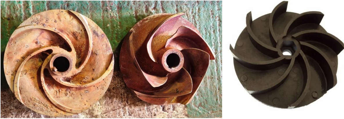
Рис. 3. Зношені (1 – 2) та нове (3) робочі колеса відцентрових насосів
