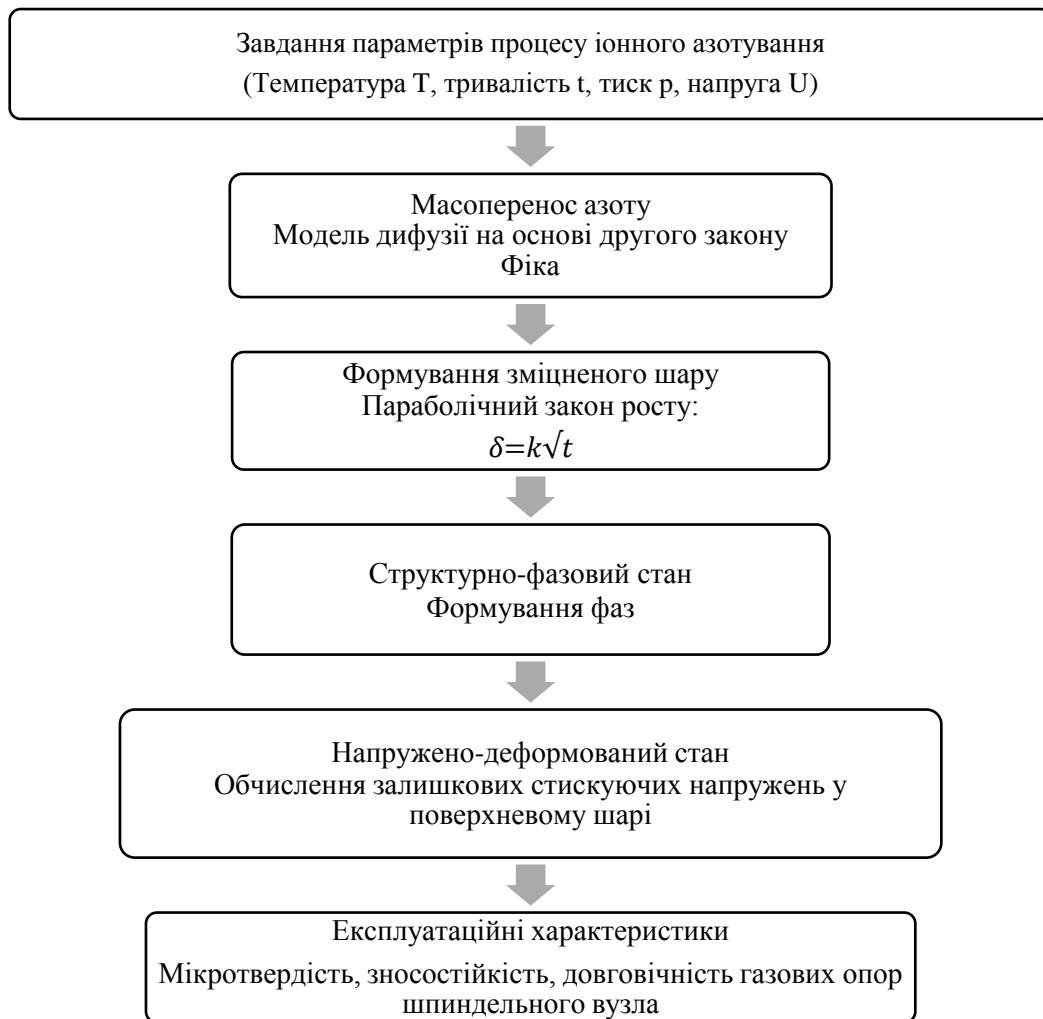
Рис. 1. Алгоритм фізико-математичного моделювання структурно-фазових та напружено-деформованих станів сталевих поверхонь після комплексного іонного азотування
