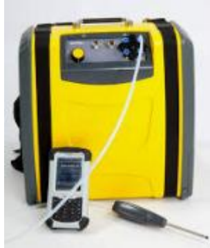
Рис. 4. Портативний газоаналізатор Gasmeter DX4040
